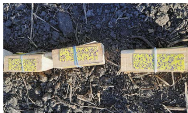
ФОТО 1. Контроль качества опрыскивания: результаты теста на водочувствительной бумаге
